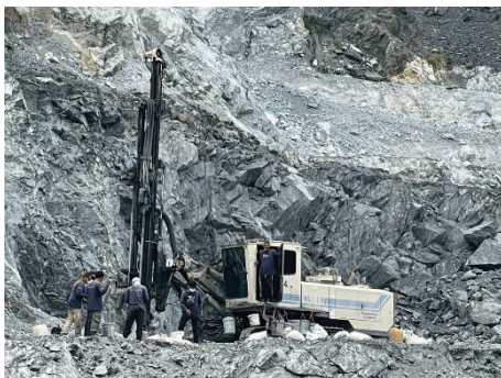
รูปที่ 2-26: รถเจาะระเบิดแบบดินตะขบ
